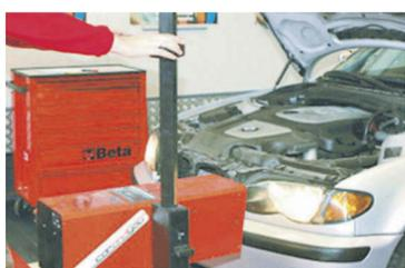
✓ **Revisión de luces.** Hay que comprobar que todo el sistema de iluminación funciona adecuadamente (luces de posición, cruce, antinieblas, largas e intermitentes tendrán que cumplir su cometido sin ningún inconveniente). Además, será imprescindible revisar el nivel de los faros y ajustarlo en función de la carga del vehículo. De esta manera evitaremos deslumbramientos al resto de vehículos y optimizaremos al máximo el haz de luz.
