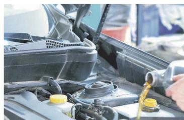
✓ **Revisar los niveles de todos los líquidos.** Es recomendable realizar siempre una revisión de todos los líquidos del vehículo, además de la comprobación del líquido limpiaparabrisas. Nos fijaremos en si los niveles de aceite y líquido refrigerante son los adecuados.
